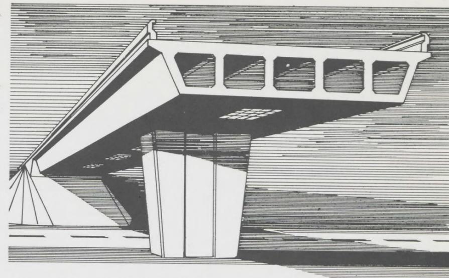
FIG. 11 / TYPICAL BOX GIRDER
